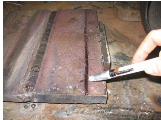
نوب گچ حرارتی با رسیدن دمای قطعه به بیش از دمای بین پاس
